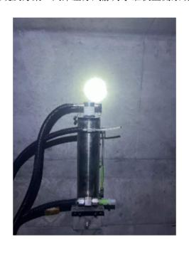
静力水准仪的使用注意事项: 1、管道连接: 为保证所有传感器内液体上方的气压相等,必须用气管把所有传感器的连接起来。但是如果在开阔地使用,且使用发为不是很大时,可认为都处于同一个大气环境下的个测点的气压都是一个相同的大气压。此时可以不使用气管,简化系统。但如果是在隧道内使用,由于列车经过时,对列车前后的气压有较大影响,此时需要使用气管连接所有测点,以避开列车对测点内气压的影响。2、液体选择: 静力水准仪一般使用水来做介质,在气温低于0°时,水会结冰膨胀,导致系统失效。因此一般使用防冻液来代替水。防冻液还可以起到消毒杀菌的作用避免水中微生物的滋长。防冻液可使用汽车水箱的防冻液,选择有色的防冻液,可直观看到管道中是否有气泡。3、水箱的使用: 无论是否使用气管来联通水箱,都必须让水箱与大气相通,否则水箱内的水不能自由流动,会导致数据误差。联通大气的水箱内的水容易蒸发,可以在水面上滴上数滴硅油,隔绝水与空气的接触,可有效防止水分蒸发。硅油可使用液态机油,或普通的矿物润滑油即可。天津差分式静力水准仪监测系统磁致伸缩式静力水准仪主要由测杆、电子仓和套在测杆上的非接触浮球组成。
