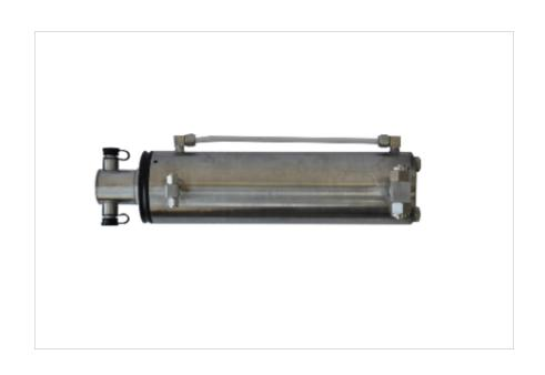
和小编来看看与静力水准仪相关的一些知识介绍,压差式静力水准仪特点: 1、体积小□100\*90\*61□5mm□□精度高□0.05%FS□□量程大□2000mm□□2□可以随着地面走势安装,不需要转点,全密封结构可以埋设于地下。3、具有宽温度补偿(-20~80℃),工作温度可达-40~125℃,适用于各种恶劣环境。4、测量点无需液面流动,只要沉降有液面压差就能实时体现,数据实时性更强。5、硬件具有RS485接口,可兼容性强□6□GPRS模块,实现远程通信。
