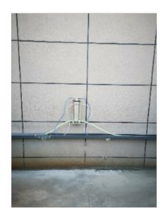
压差式静力水准仪会从储液罐开始加液。加注液体时,末端传感器的通液管是打开的,这样才能将通液管内的空气排出。由于加注时可能带入气泡,也需要将加注的前段防冻液排出,并视情况让液体循环流动。加注
