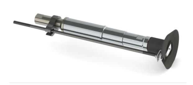
射钉击发器吹灰器作业规程:吹灰器简介及首要参数:本公司出产的PS-AT型回转式射钉击发器吹灰器首要用于清洗回转式射钉击发器热交换面。其吹扫才华大于多喷嘴式吹灰器,并能打败因预热器翻滚发作的吹扫区域不均匀及其它方案疑问.本吹灰器的动作原理为行进间歇式后退为直动式,行进服装有多个喷嘴的吹灰喷嘴管从预热器外侧向前移动至预热器基地作逐渐吹扫,吹灰管每行进一步,即连续移动,对热交换面作一次或屡次环状吹扫,可使每个区域得到有用吹扫.本吹灰器首要有大梁、齿轮箱、行走箱、吹灰外管、喷嘴管、阀门、开阀组织、前部托轮组及炉墙接口箱等构成。
